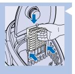
3 用力揿下装有清洁过滤器的过滤器架,确保它在底部适当就位。
