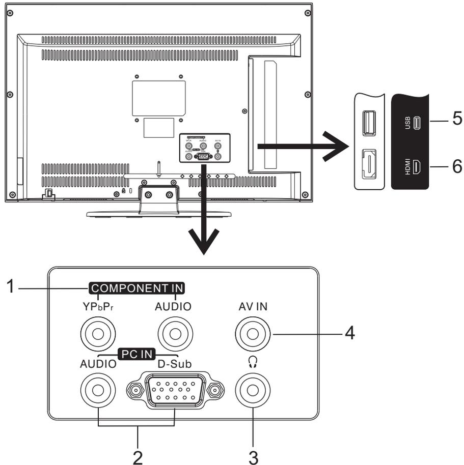
1. COMPONENT(模擬高畫質)輸入端：此組端子與DVD機或帶有YPbPr/YCbCr輸出端子的設備連接。
