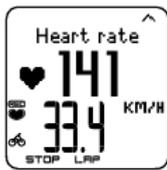
按住UP（向上）按钮可以缩放显示上行，并且按住DOWN（向下）按钮可以缩放中行。再次按住该按钮，返回正常显示状态。
