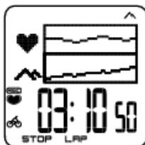
您可对图表查看方式进行个性化设置、在上部与中部的行上，您可以选择以图表方式查看Power能量，Speed速度，Altitude海拔高度或者Heart rate心率数值。
