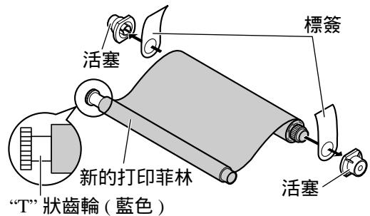
**5** 把藍色的打印菲林軸扣入傳真機右邊的扣孔（①），然後再把“T”狀齒輪（藍色）扣在左邊的扣孔上（②）。
