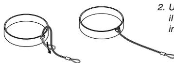
2. Usate l'attacco per fissare il cordoncino alla parte inferiore del proiettore.
