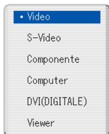
Premete e rilasciate rapidamente il tasto SOURCE sull'involucro del proiettore per visualizzare la lista Fonte. Ad ogni pressione del tasto SOURCE, la fonte d'ingresso cambia nel seguente modo: "Video" (VCR o lettore LD) o S-Video, "Componente" (lettore DVD), "Computer", "DVI (DIGITALE)" (Computer) o "Viewer" (diapositive su una PC Card). Premete il tasto ENTER per visualizzare la fonte selezionata.
