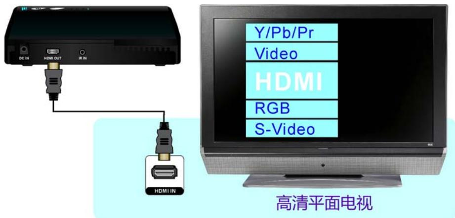
(5) 按下遥控器 Source 1HDMI 2HDMI 3YPbPr 4YPbPr 按键，选择您连接至 GBS330T 的高清设备影音来源。
