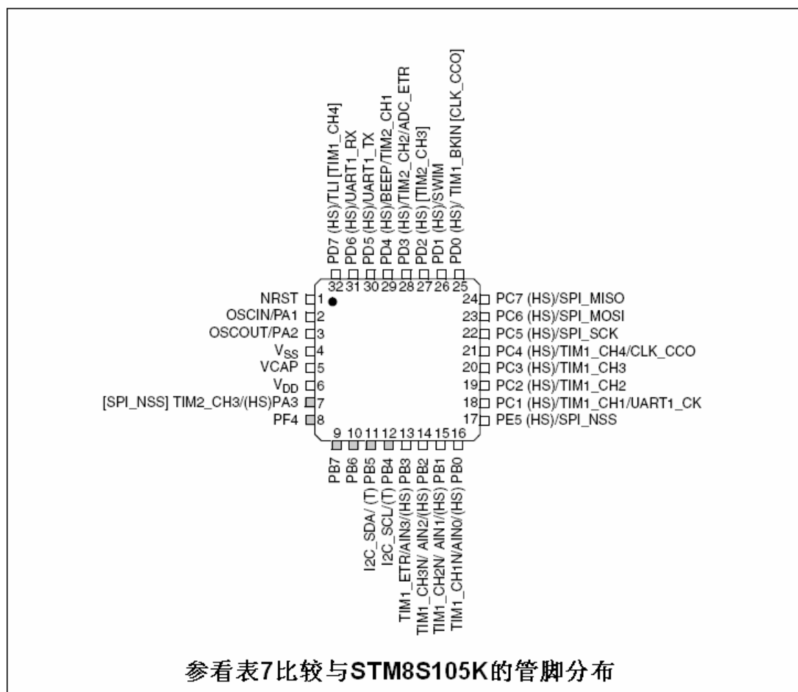
图3 STM8S103K VQFN32/LQFP32引脚
