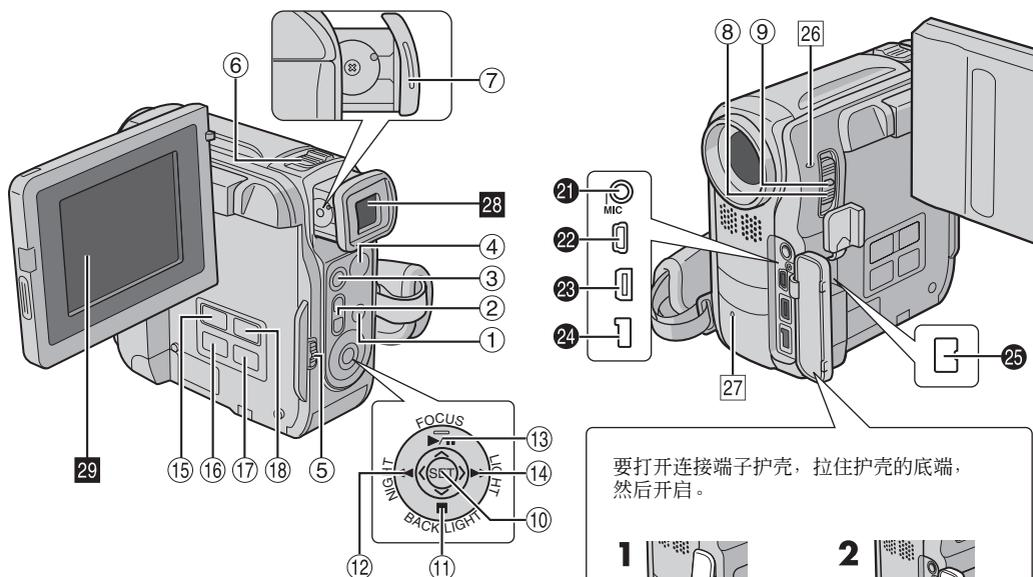
要打开连接端子护壳，拉住护壳的底端，然后开启。
