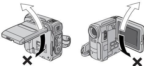
液晶监视器不可以从上图所示的位置向下旋转（X 方向）向错误的方向旋转可能会引起故障。请确定向正确的方向旋转。
