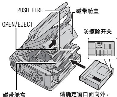
**1** 按照箭头的方向滑动并按住 OPEN/EJECT，然后打开磁带舱盖直至锁定。磁带舱盖自动打开。
