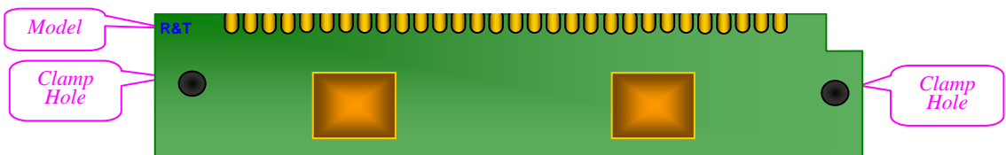
图 2-12 录音外线联合模块(正视图)
