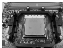
步骤 4： 下推并锁住插座拉杆
