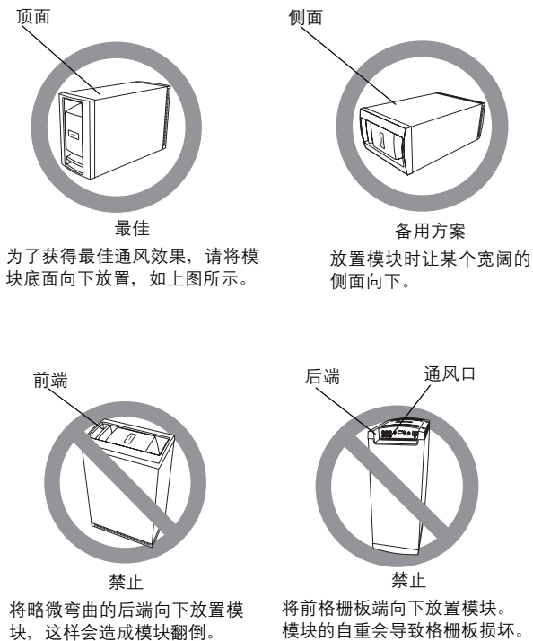
图 9 Acoustimass 模块的正确和错误摆放位置
