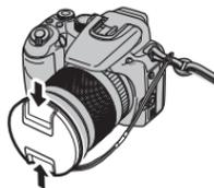
为避免丢失镜头盖, 请将附带的细绳穿过穿孔并将镜头盖挂在肩带上。
