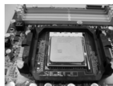
步骤 4： 下推并锁住插座拉杆
