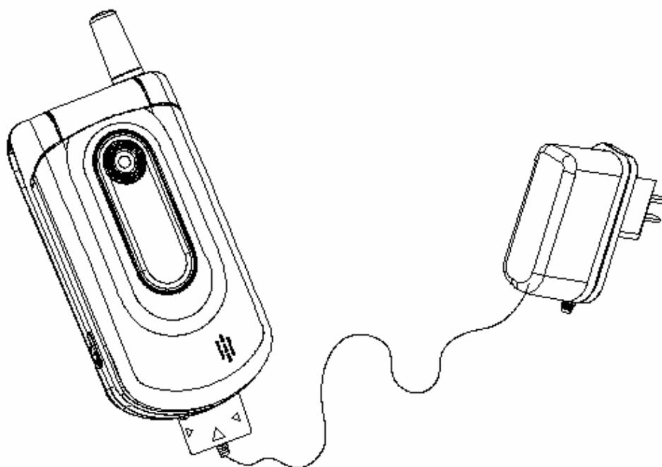
**？ 注意：** 不要强制拔出充电接口，这样可能会损坏手机或充电器，充电结束后，按充电接口两侧的按键后将手机与充电器断开。
