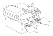
2 用双手将纸张装入手动进纸槽,直到纸张前缘触到进纸辊。设备进纸时,请松开纸张。
