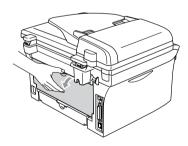
4 将滑块朝操作者方向拉出打开后部斜槽盖。
