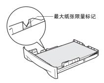
**5** 使用设备前,将纸盒牢固的放回设备并展开出纸盒托纸板。
