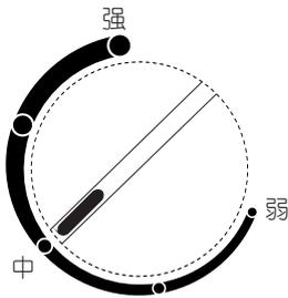
冷藏室温度调节旋钮位于冷藏室风道盖板上方，是通过控制风道盖板上出风量的大小来控制冷藏室的温度的。
