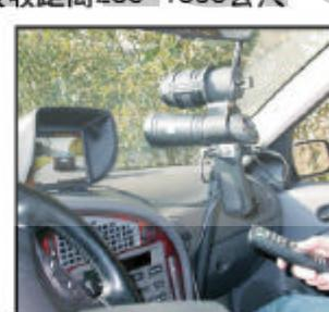
E:流动式雷射系统：锁定照相距离：150m~350m；雷射侦测器接收距离100~1500公尺
