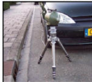
B:流动式Ka照相系统：锁定照相距离：10m~30m；雷达侦测器接收距离250~1500公尺
