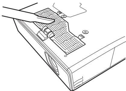
当难以用真空吸尘器清除滤网上的灰尘时，请拆下空气滤网进行清洗。
