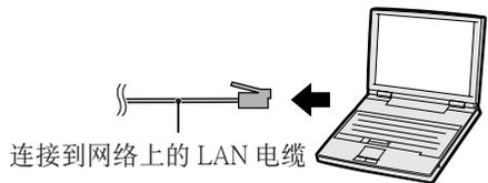
**2** 将商店有售的 LAN 电缆（UTP 电缆、5 类双绞线）的一端连接到投影机 LAN 端子，将电缆的另一端连接到电脑的 LAN 端子。
