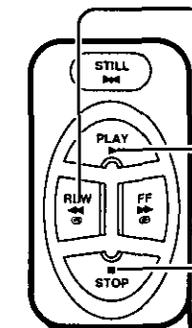
**2** Rebobinar la cinta con el botón de rebobinado (REWIND) (si fuera necesario).
