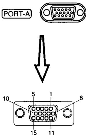
Pin assignments of 15 pin mini D-Sub connector
