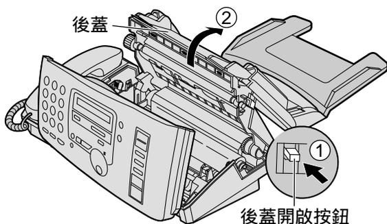
**3** 從藍色齒輪的一邊拉起，取出用完的打印菲林，然後再取出用完的打印菲林軸。
