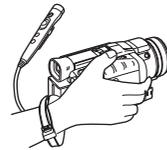
● 重新将手执带连接到手执带的接合部分，直到其发出卡嗒声。
