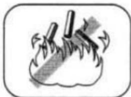
如果将电池投入火中、或进行加热、分解、充电和短路，可能会引起放热、燃烧或破裂。非常危险，因此请绝对不要做此类事情。另外用完的电池请根据各地方自治团体的规定作为一般的废弃物处理。
