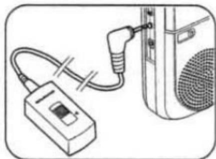
将遥控器开关连接到本机的遥控器插孔 ④ 上。
