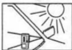
请不要将本机置放于直射阳光下的汽车中、夏天的海边、高温高湿的地方以及强磁场的地方。
