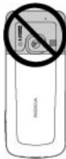
您的设备可能装有内置和外置天线。当天线发射或接收信号时，如非必要，请勿接触天线。接触天线会影响通信的质量，可能导致设备在电量级别较高的状态下工作，且可能缩短电池的寿命。
