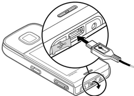
打开 USB 插孔的保护盖，然后将 USB 连接线连接至设备。
