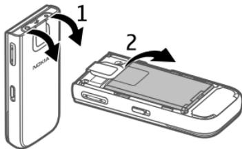
2 打开 SIM 卡卡夹。将 SIM 卡插入卡夹，触点面朝下。合上 SIM 卡卡夹。
