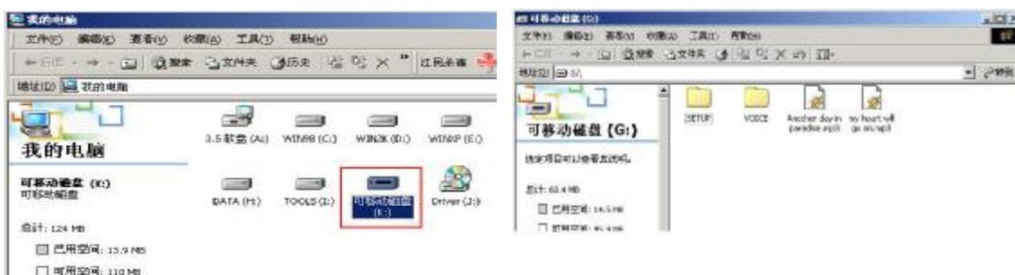
MP3 播放器与计算机 USB 口连接，LCD 显示如下左图。MP3 播放器与移动硬盘工作方式相同，资料的上传/下传与硬盘使用方法相同，可对文件进行拷贝和删除操作。在下载文件的过程中，LCD 上闪烁显示"WRITING"、"计算机/播放器"的图标间的有"象形"图标穿梭，表明正在通讯，通讯完毕"象形"图标消失。
