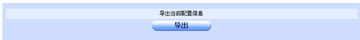
◆ “导出”按钮：单击此按钮将在设备上下载 startup-config 文件，该文件保存了当前设备的配置信息。
