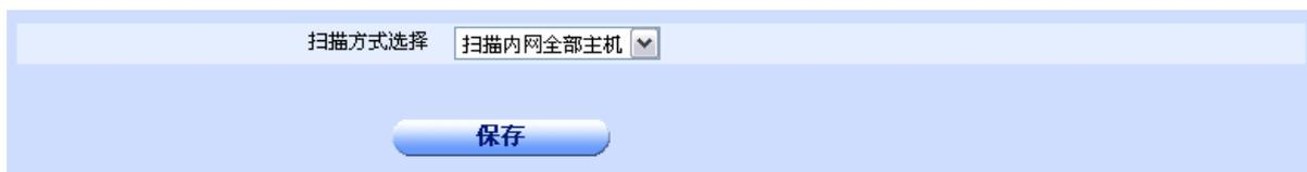
◆**扫描方式选择**：可以选择“扫描内网全部主机”，“手动指定扫描范围”和“禁止扫描 ARP”。默认显示当前设备已使用的扫描方式。
