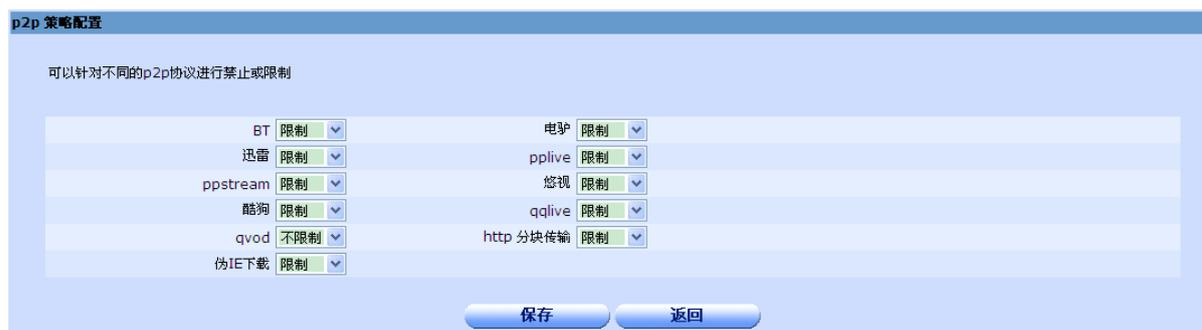
目前支持 11 种 p2p 协议，每种协议可以选择不限制，限制或者禁止，如果选择禁止，则不能使用此 p2p 协议进行下载，值得注意的是，一般的下载软件都支持多种协议，例如迅雷支持 HTTP 分块传输、伪 IE 下载和 QQ 直播（QQLive）三种协议，因此要限制或者禁止某种 p2p 下载软件，最后把 http 分块传输和伪 IE 下载也选择相同的操作。
