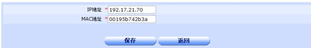
◆**IP 地址**：设置 ARP 绑定的 IP 地址，格式为点分十进制 IP。
