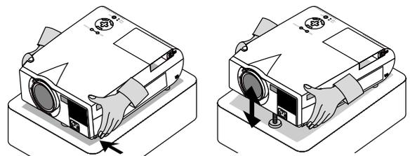
6. Für die vertikale Feineinstellung der Bildposition auf dem Projektionsschirm drehen Sie, falls erforderlich, jeden einzelnen der vorderen und hinteren Kippfüße. Wenn das projizierte Bild nicht rechtwinklig zum Projektionsschirm erscheint, führen Sie die Trapez-Korrektur für die richtige Einstellung aus. Die Höhe jedes hinteren Fußes kann um bis zu 4 mm verändert werden.
