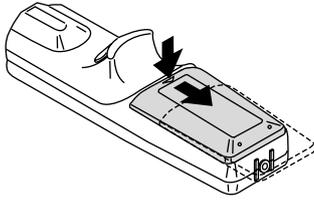
2. Entfernen Sie die beiden alten Batterien und legen Sie neue (Typ AA) ein. Stellen Sie sicher, daß die Polarität der Batterien (+/-) richtig ausgerichtet ist.
