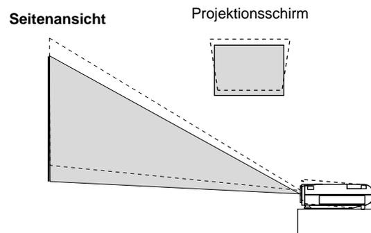
(Mit Hilfe der vorderen Kippfüße läßt sich das Bild um ca. 5 Grad nach oben bzw. unten verschieben.)
