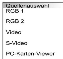
Hiermit wählen Sie unabhängig davon, was an den Eingängen angeschlossen ist, eine der folgenden Videoquellen aus: VCR, DVD-Player, Laserdisc-Player, Computer oder Dokumentenkamera. Drücken Sie die "Select"-Taste am Projektorgehäuse oder die ▲▼ Tasten auf Ihrer Fernbedienung, um zu markieren, welche Funktion Sie einstellen möchten.
