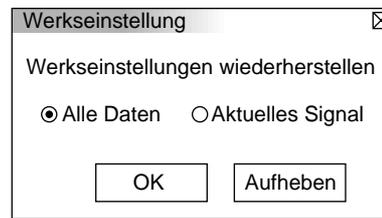
Stellt alle Einstellungen und Eingaben für jede einzelne Quelle - mit Ausnahme der Lampenbetriebsstunden - auf die Hersteller-Voreinstellungen zurück. (Für die Rückstellung der Lampenbetriebsstunden beziehen Sie sich bitte auf das Kapitel "Löschen des Lampenbetriebsstunden-Zählers" auf Seite G-23.
