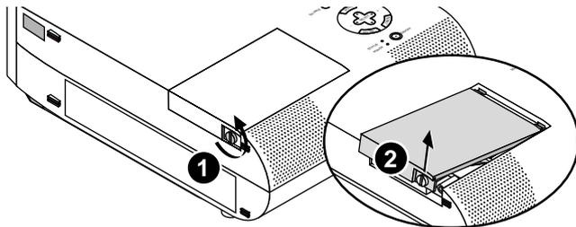
2. Lösen Sie die zwei Befestigungsschrauben des Lampengehäuses bis der Schraubendreher frei läuft. Die zwei Schrauben können nicht entfernt werden.
