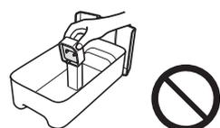
否則浮體無法偵測水位狀況，從而導致漏水，並可能損壞周圍的物品或引起觸電和（或）漏電事故。
