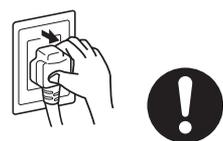
不按筆直方向或拉扯電線拔下插頭會損壞插頭的插銷或芯線，並可能引起短路、觸電或火災事故。
