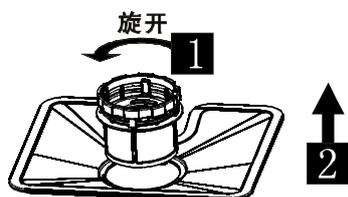
第一步：逆时针旋转柱面过滤器，然后往上提，取出微过滤器和粗过滤器。
