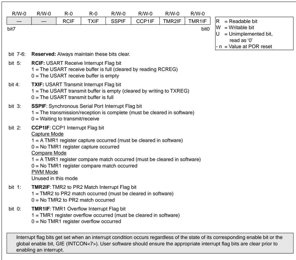
**FIGURE 4-18: PIR1 REGISTER FOR PIC16C64/64A/R64 (ADDRESS 0Ch)**
