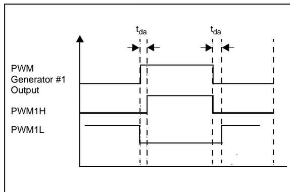
**FIGURE 12-16: DEAD-TIME CONTROL UNITS BLOCK DIAGRAM**
