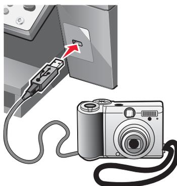
**注意：**请确认 PictBridge 兼容数码相机被设置为正确的 USB 模式。请参阅随同数码相机一起的说明文档获取更多的信息。
