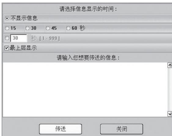
此对话框将在您点击重启、关机、使用者模式、管理员模式、保留模式、备份、还原、指定启动盘、取消指定启动盘、维护排程、传递硬盘保护参数等按钮后弹出，由于以上功能均需要使被控端计算机重启或关机，因此该对话框可以根据您的需要使得被控计算机延迟相应的时间进
