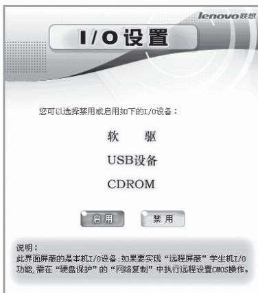
在此处您可以启用 / 禁用软驱、USB 设备、CDROM 设备。禁用后这三种设备将无法在操作系统中使用。设置完成后您可以结合硬盘保护系统中传送 CMOS 参数功能使网络中所有接收端计算机均启用 / 禁用这三种设备。
