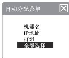
**机器名：**选择此项，可以自动将所登录的计算机名称按发射端的设定依次增加。例如：将发射端 Computer Name 设为 ABC，则接收端计算机按连线编号顺序自动依序设定机器名为 ABC001，ABC002，ABC003~ABC200。
