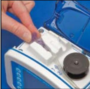
Tome la orejeta en la válvula e insértela firmemente en la cavidad izquierda. Oprima hacia abajo la orejeta para asegurar que la válvula esté bien ajustada. La orejeta debe estar alineada con la ranura en la tapa azul. La tapa azul no se podrá cerrar si la orejeta no está bien ajustada.
