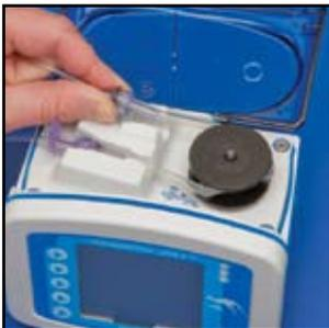
Tome el sujetador de anillo negro y suavemente pase el tubo alrededor del rotor e inserte el sujetador en la cavidad derecha. **NO AJUSTE EN EXCESO LOS TUBOS.**
