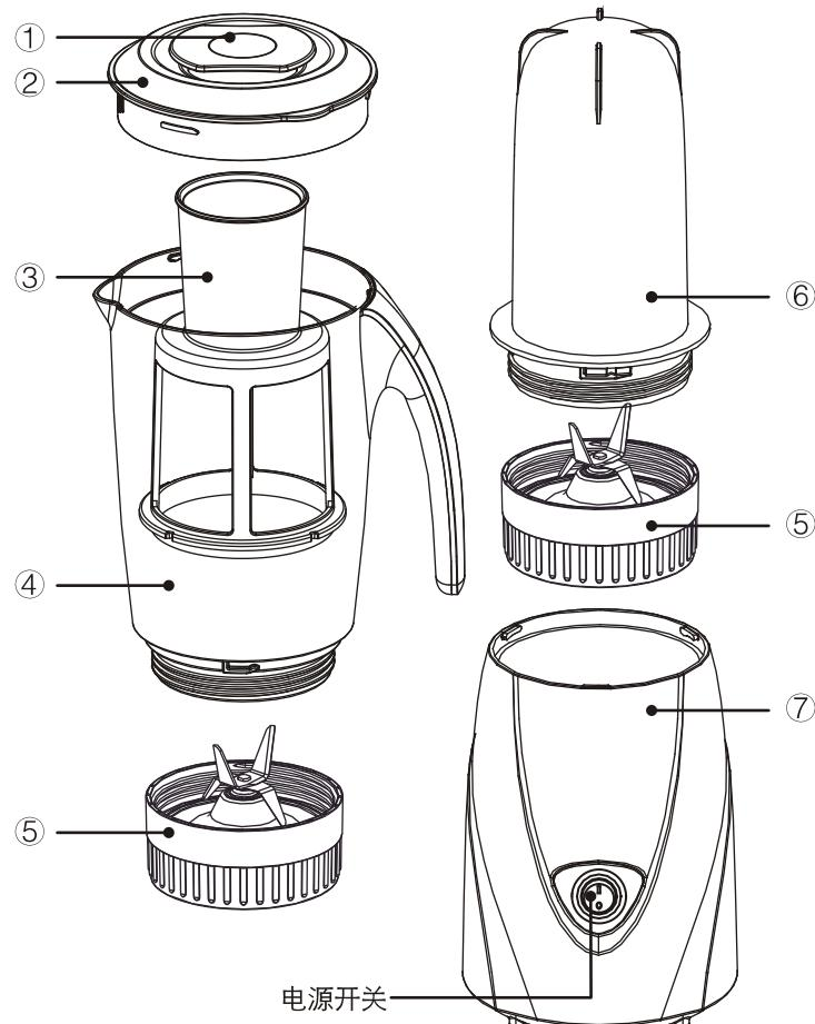
7. 不要直接用水冲洗主机，否则会造成电机和连接开关发生故障及事故。
