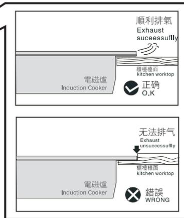
注意：安裝時必須確保後排氣口高於檯面，使之能正常出風（如上圖所示）。
