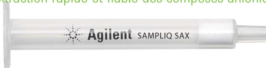
La résine SampliQ Agilent d'échange d'anions forts (SAX) est une résine polymère de divinylbenzène modifié par une amine tertiaire, de mode mixte, qui a à la fois une fonction d'échange d'anion et de phase inverse. En conséquence, la résine SampliQ SAX présente une excellente rétention des composés acides et neutres dans une large plage d'hydrophilie (log P).
