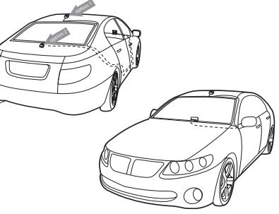
Si el vehículo es convertible con toldo suave, es posible colocar la antena en la tapa metálica de la cajuela. Debe estar al menos a 10 cm (4 pulg) de la ventana trasera. Cerciórese que la antena y el cable no interfieran con la apertura y el cierre del toldo convertible y la cajuela.
