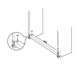
将踏板单元的插头如图所示摆放,并插入钢琴底部的踏板插座 用夹子固定踏板线。
