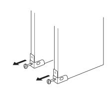
3 将踏板单元两端的插板插入侧板边缘与金属片间的空隙中。 \* 下图介绍金属片的一种安装方法,如此安装金属片能防止支架翻倒
