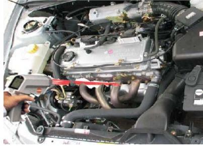
使用红外测温仪确定燃烧不好的汽缸，启动发动机空转直到稳定。测试每个排气门的温度，记下温度变化。请参阅图
