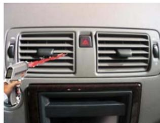
**小心：**为了避免红外测温仪的热冲击，当测量空调管道表面温度或测量其它空调管道附近组件的温度时，不要直接将仪器放在空调出风口气流中。测量时仪器应偏在一侧以避免与冷气流直接接触。
