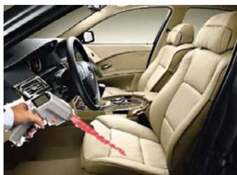
使用红外测温仪在关闭所有座椅加热功能时测量加热座椅和/或座椅靠背表面的温度。测量其它座椅来获取座椅表面的综合温度。所有座椅之间的温度应当接近。如果某座椅的表面温度明显较热，作为加热功能可能工作了。下一步，点火将座椅加热功能设置在低档并给出 5 分钟时间让座椅温度稳定。再次测量加热座椅垫和/或座椅靠背表面的温度测试低档温度读数是否接近 35°C（98°F）。下一步，将座椅加热功能设置在高档并给出 5 分钟时间让座椅温度稳定。再次测量加热座椅垫和/或座椅靠背表面的温度。检验高档温度读数是否接近 45°C（110°F）。如果温度读数较高或较低，则使用相关的服务住处诊断座椅加热功能系统。
