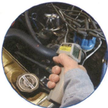
节温器打开时的温度：当发动机到达正常运转温度，大多数车辆是大约 85—105°C（190—220°F），节温器应该打开并允许冷却液流过散热器。当发动机到达运转温度，使用红外测温仪测量在靠近节温器外壳的上部散热器软管处的温度。当在指定的温度上将节温器打开时，上部散热器软管的温度应该迅速上升。如果在靠近节温器外壳的上部散热器软管处的温度没有上升，请检查以下各项：
