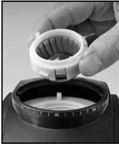
Assurez-vous que l'anneau d'ajustement noir est tourné dans le sens inverse des aiguilles d'une montre aussi loin que possible. Replacez le broyeur en alignant la languette rouge avec l'entaille rectangulaire sur l'anneau d'ajustement noir. Secouez légèrement et poussez le broyeur circulaire fermement vers le bas pour vous assurer qu'il est correctement placé.
