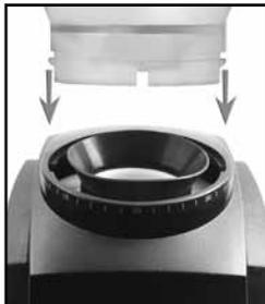
Pour remettre la trémie à grain en place, alignez les deux petites languettes de la base de la trémie (avec la petite encoche sur le côté droit) avec leurs rainures respectives au sommet du chemisage du moulin et insérez la trémie dans le moulin. Une fois la trémie en place, tournez dans le sens des aiguilles d'une montre jusqu'à votre réglage de mouture désiré.
