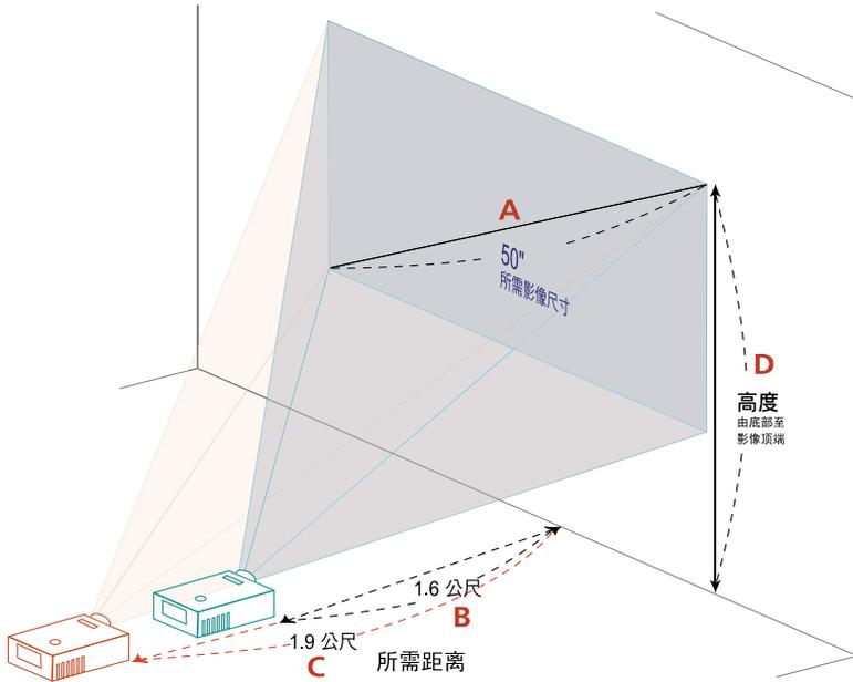
下表显示如何通过调节位置或变焦环来实现所需的图像尺寸。例如：如要获得 50 英寸的图像尺寸，可以使投影机距离屏幕 1.6 米到 1.9 米，然后相应地调整变焦倍数。
