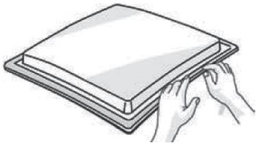
Coloque el anafe en la abertura realizada en la mesada respetando las dimensiones indicadas en las instrucciones de instalación.
