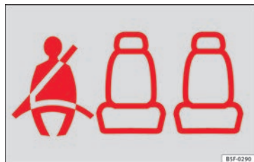
Fig. 96 Cuadro de instrumentos: indicación de plaza posterior derecha ocupada y abrochado el cinturón correspondiente.
