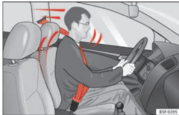
Fig. 97 Los conductores que lleven el cinturón de seguridad correctamente abrochado no saldrán lanzados en caso de un frenazo brusco.
