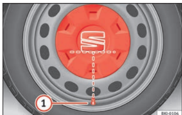
Fig. 76 Colocación correcta del embellecedor central de rueda para llantas de acero.
