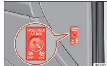
Fig. 22 Conmutador del airbag frontal del acompañante.
