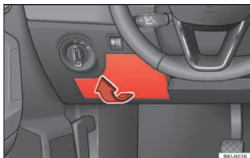
Fig. 69 En el tablero de instrumentos del lado del conductor: tapa de la caja de fusibles.
