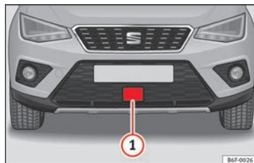
Fig. 188 En el paragolpes delantero: sensor de radar.
