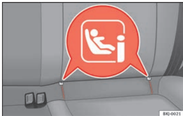
Fig. 30 Anillas de sujeción ISOFIX/iSize.
