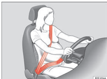
Fig. 101 Colocación de la banda del cinturón en el caso de mujeres embarazadas.
