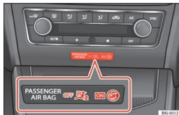
Fig. 55 Testigo para desconexión de airbag del acompañante.
