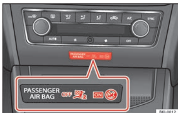
Fig. 103 Parte central del tablero de instrumentos: testigo de control de la desactivación del airbag del acompañante.
