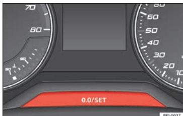
Fig. 125 Cuadro de instrumentos: cuentakilómetros y tecla de puesta a cero.
