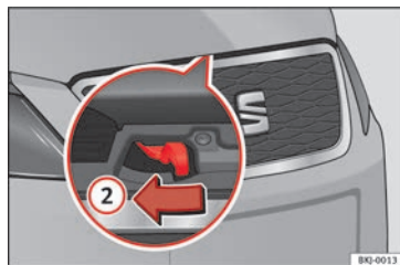
Fig. 10 Palanca bajo el capó.
