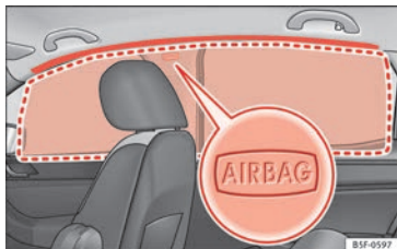
Fig. 25 Ubicación y zona de despliegue del airbag para la cabeza.
