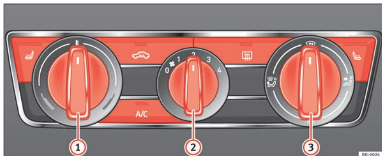
Fig. 61 En la consola central: mandos del aire acondicionado manual.
