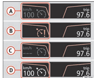
Fig. 183 Pantalla del cuadro de instrumentos: indicaciones de estado del GRA.
