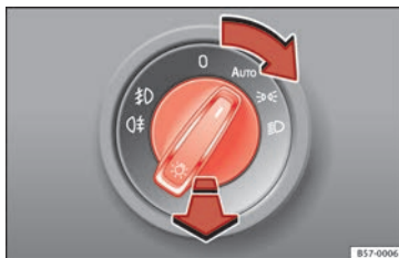
Fig. 37 Tablero de instrumentos: mando de las luces.
