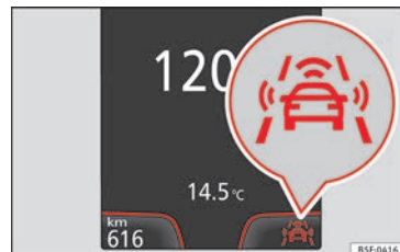
Fig. 189 En la pantalla del cuadro de instrumentos: indicación de Front Assist desactivado.
