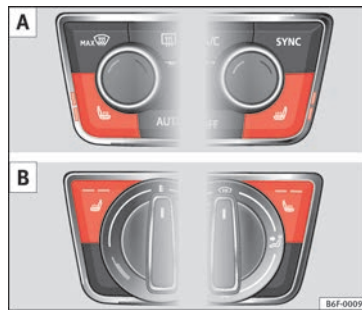
Fig. 152 En la consola central: mandos para la calefacción de los asientos delanteros. [A]: versión con Climatronic. [B]: versión con aire acondicionado manual.
