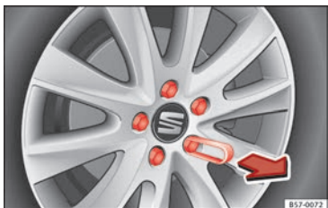
Fig. 79 Rueda: tornillos de la rueda con capuchones.
