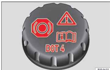
Fig. 67 Vano motor: tapón del depósito del líquido de frenos.
