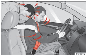
Fig. 99 El ocupante del asiento trasero que no lleve puesto el cinturón de seguridad se verá lanzado hacia delante sobre el conductor que sí lleva el cinturón.
