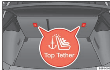
Fig. 31 Posición de las anillas Top Tether en la parte posterior del asiento trasero.
