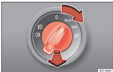
Fig. 144 Tablero de instrumentos: mando de las luces.
