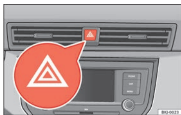
Fig. 39 Tablero de instrumentos: conmutador de los intermitentes de emergencia.
