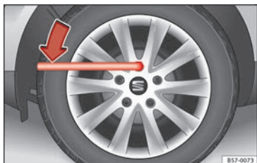
Fig. 80 Cambio de rueda: aflojar los tornillos de rueda.
