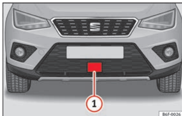
Fig. 195 En el paragolpes delantero: sensor de radar.
