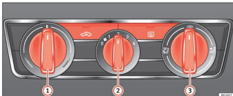
Fig. 62 En la consola central: mandos del sistema de calefacción y aire fresco.
