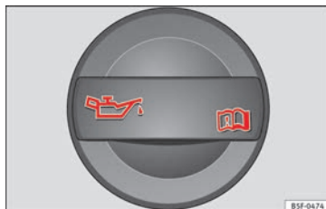
Fig. 65 Tapón de la boca de llenado de aceite del motor en el vano motor.
