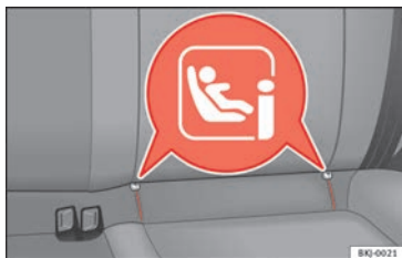
Fig. 32 Anillas de sujeción ISOFIX/iSize.
