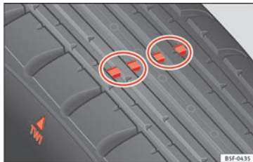
Fig. 239 Indicadores de desgaste del perfil del neumático.
