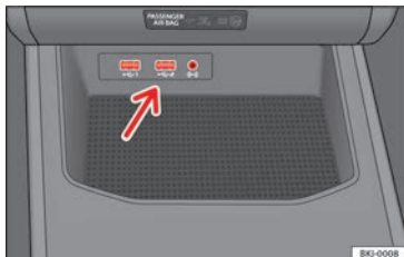
Fig. 129 Consola central: entrada USB/AUX-IN.
