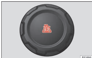
Fig. 66 Vano motor: tapón del depósito de expansión del líquido refrigerante.
