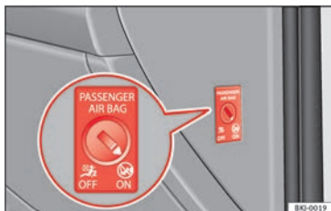
Fig. 102 Conmutador con llave para activar y desactivar el airbag del acompañante.
