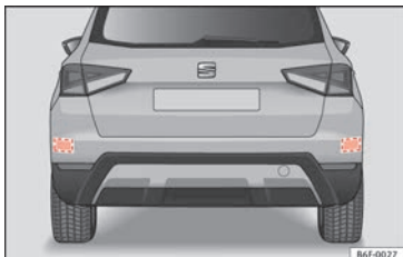
Fig. 202 Vista trasera del vehículo: zonas de los sensores de radar.
