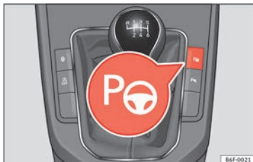
Fig. 209 En la consola central: tecla para conectar el sistema de aparcamiento asistido.
