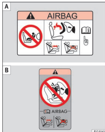
Fig. 27 Adhesivos del airbag - versión 1: en el parasol del lado del acompañante A y en el marco posterior de la puerta del acompañante B .
