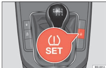
Fig. 241 Consola central: tecla del sistema de control de los neumáticos.
