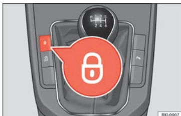
Fig. 3 Consola central: pulsadores del cierre centralizado.
