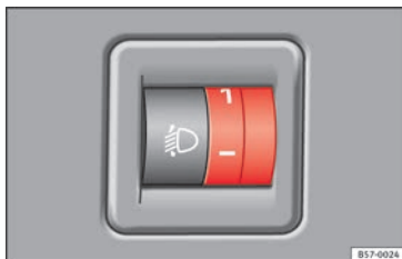
Fig. 146 Tablero de instrumentos: regulador del alcance de los faros.
